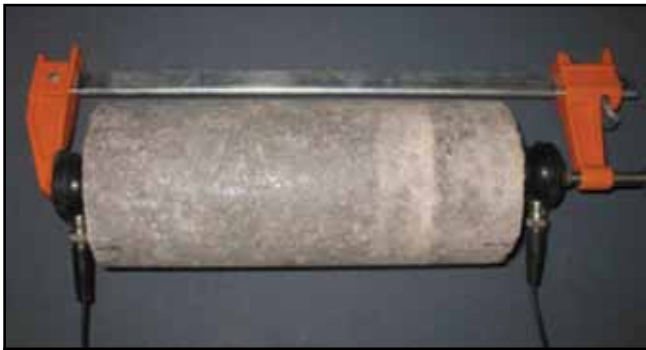
Figure 4. Salt core ultrasonic measurement (N. Dyaour photo)
